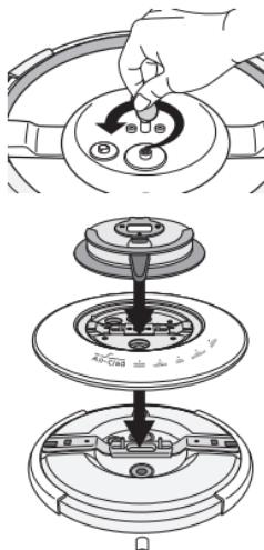
Pour fixer le module de commande sur le couvercle :
