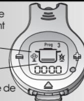
Sélectionner la position **PRESSURE RELEASE**, et la vapeur chaude s'échappe de l'évent.
